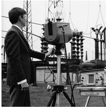
Figur 14.2 1969: Thermovision-modell 661. Kameran vägde cirka 25 kg, oscilloskopet 20 kg och stativet 15 kg. Operatören behövde dessutom en 220 V växelströmgenerator och en 10-litersbehållare med flytande kväve. Till vänster om oscilloskopet syns Polaroidtillsatsen (6 kg).
