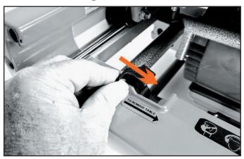
▲ WARNING! IF THE REMOVE TABLE LOCK LEVER IS LEFT IN THE DOWN POSITION INADVERTENTLY THIS COULD CAUSE DAMAGE AND/OR INJURY
